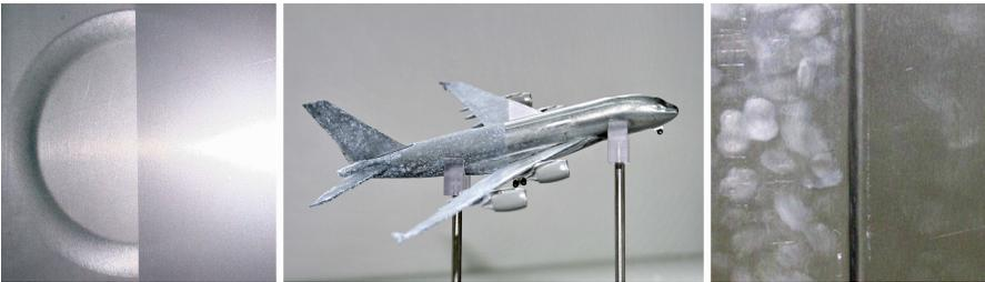
Abb. 11. Anwendungsbeispiele der Chemischen Nanotechnologie aus dem Leibniz-Institut für Neue Materialien in Saarbrücken: abriebfest (links), Korrosionsschutz auf einem Zinkdruckguss-Flugzeugmodell (mitte) und anti-fingerprint auf Edelstahl (rechts) – jeweils halbseitig beschichtet.
