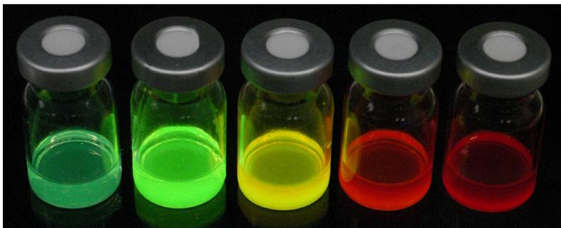
Abb. 4. Fluoreszenz von Cadmium-Selenid-Quantenpunkten. Bei der Beleuchtung mit UV-Licht fluoreszieren die Suspensionen in Abhängigkeit von der Teilchengröße (Aufnahme: NASA).
